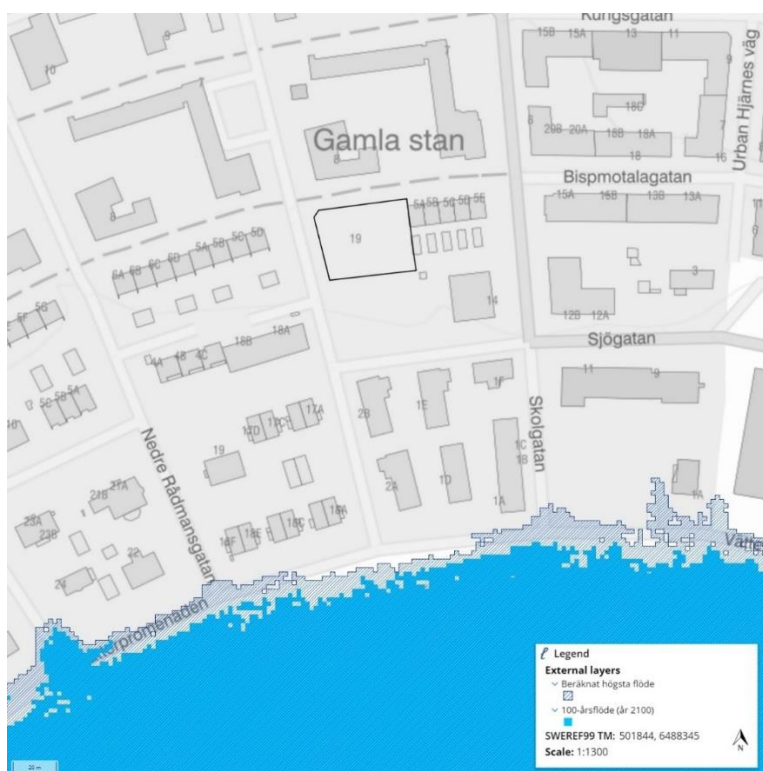
Figur 9. Urklipp från Scalgo Live med MSB:s översvämningskartering. Utredningsområdet är markerat i svart.
