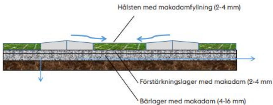
Figur 12. Principskiss-genomsläpplig beläggning 21
