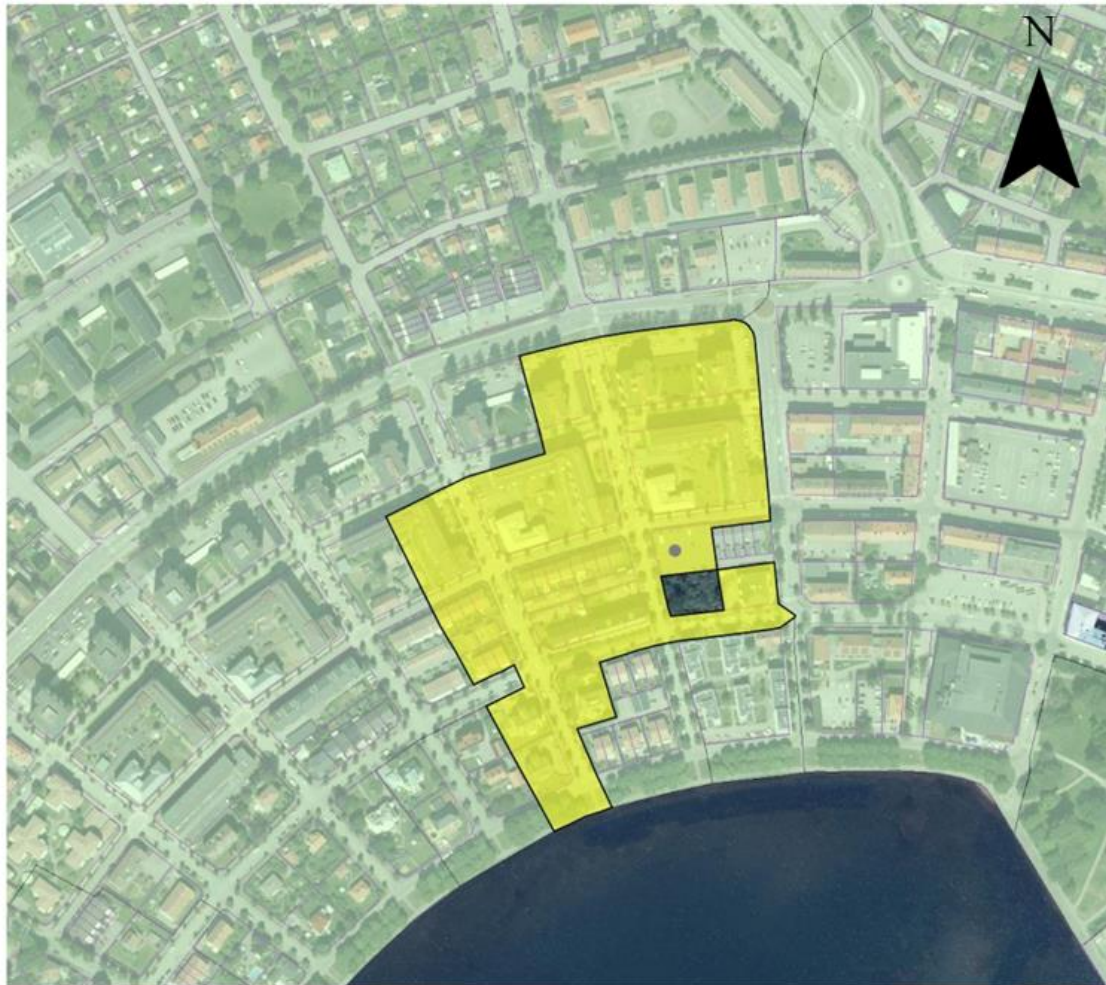
Figur 8. Avrinningsområde för dagvattenledning där fastigheten Bonden 3 ingår. Fastigheten är markerad med grå punkt. 12
