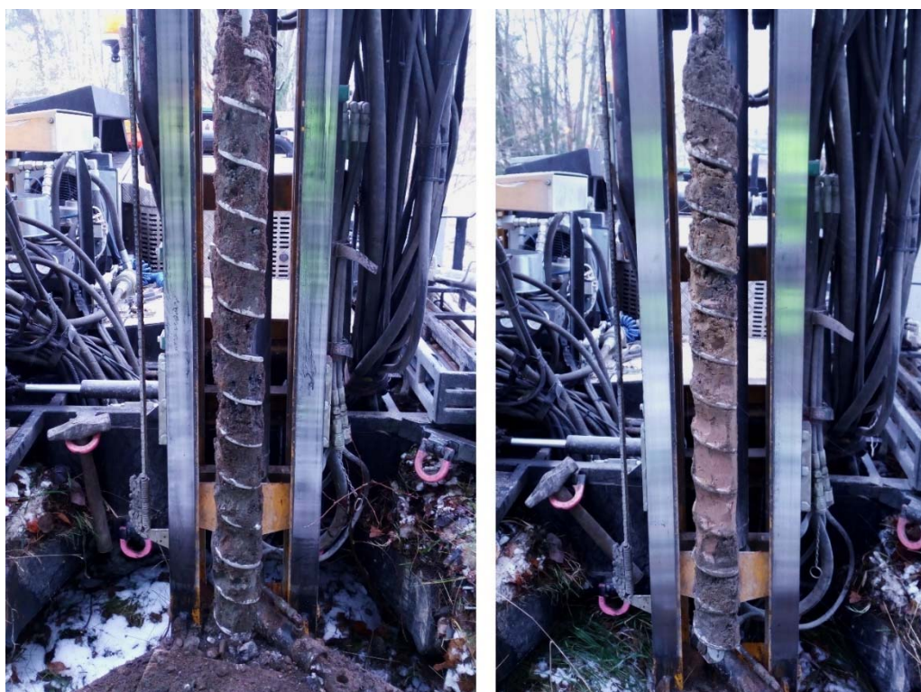
Figur 5 T.v. 1702 1-2 m (fyllning, bl.a. asfalt), t.h. 1701 4-5 m (fyllning?)
