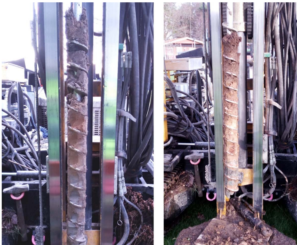
Figur 7 T.v. 1707 2-3 m (naturlig finsand) t.h. 1709 0-1m (fyllning)
